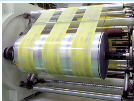
塑料包材 - 八色水性柔版印刷設備
