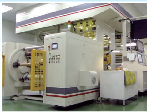
塑料包材 - 八色水性柔版印刷設備
