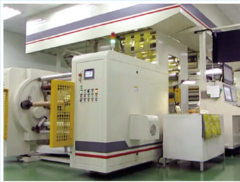
塑料包材 - 八色水性柔版印刷設備
