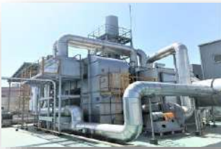
沸石濃縮轉輪搭配焚化系統 Rotor Concentrator + Thermal Oxidizer
