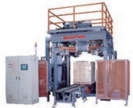
SHC2-54 冷收縮膜機 Stretch Hooder
