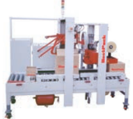
CS 全自動摺蓋封箱機 Random Carton Sealer
